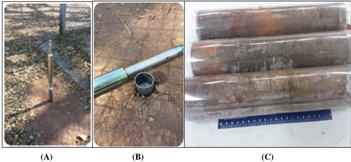
A) Inserção do amostrador; B) Retirada da amostra; C) Liners contendo amostras de solo. Fonte: Autor (2018).
