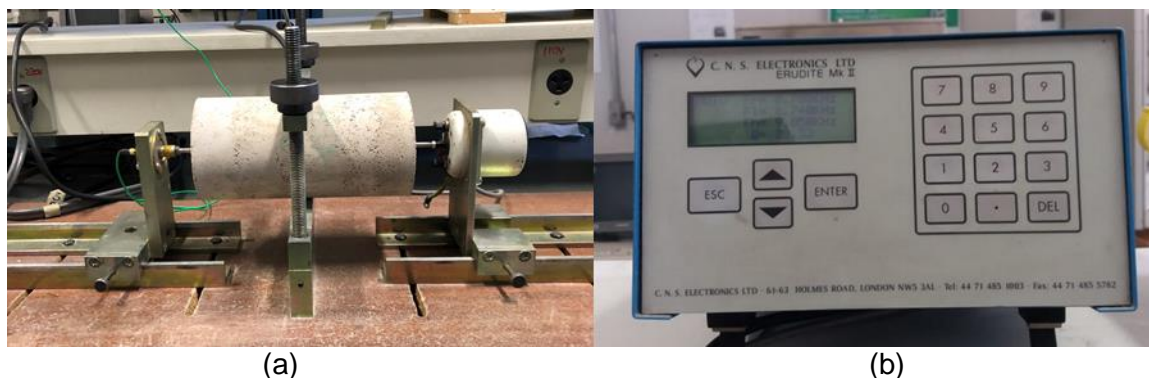
Figura 4 – Equipamento e montagem do ensaio de módulo de elasticidade.
