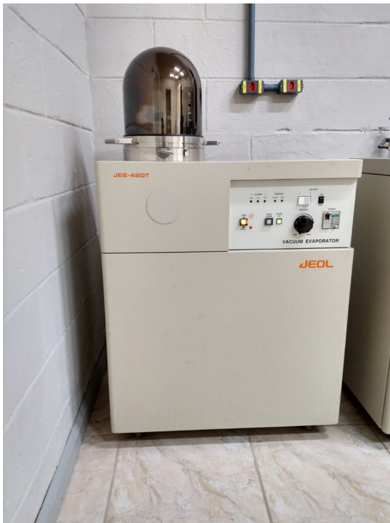
Figura 3.26 – Evaporador a vacuum utilizado na atomização das amostras por carbono.
