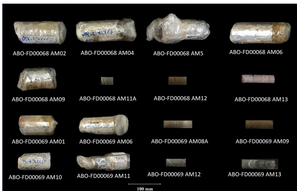
Figura 3.17 – Amostras em que se realizou a elaboração de modelos tridimensionais de e atenuação linear de feixes de raio x e com a porosidade total medida através da técnica de Microtomografia por Raio-x.
