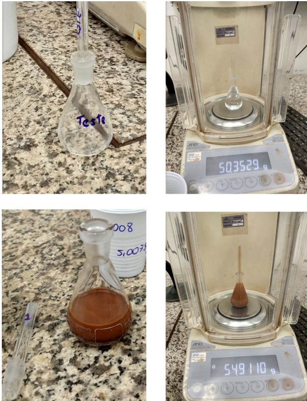
Figura 3.29 – Etapas de quantificação do volume da amostra por picnometria. Topo a esquerda picnômetro utilizado no ensaio. Topo a direita massa do picnômetro mais água. Inferior a esquerda massa de amostra diluída. Inferior a direita massa da amostra completada por água.
