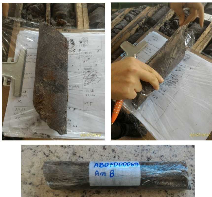
Figura 3.5 – Processo de envelopamento das amostras com filme osmótico de PVC.
