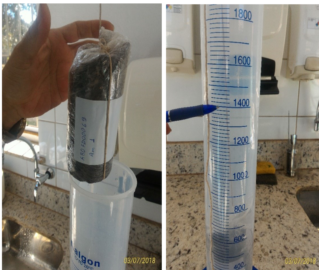
Figura 3.10 – Processo de medida de volume pela técnica de deslocamento de volume. A proveta foi completada com água até o volume de 1000mL e posteriormente a amostra foi inserida gerando um deslocamento de volume de 400mL.
