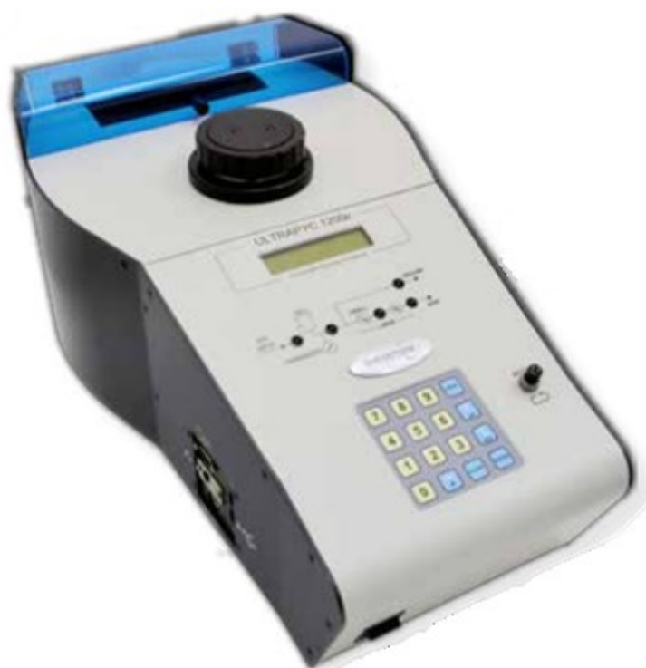
Figura 3.28 – Picnômetro a gás modelo Ultrapyc 1200e (Quantachrome, 2019);
