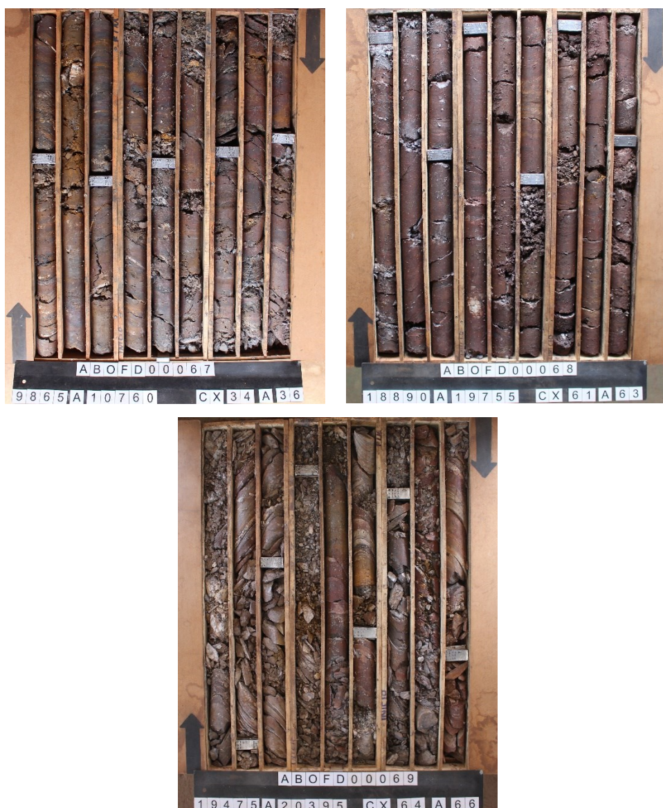
Figura 3.2 – Fotografia de intervalos de sondagem com materiais friáveis íntegros.
