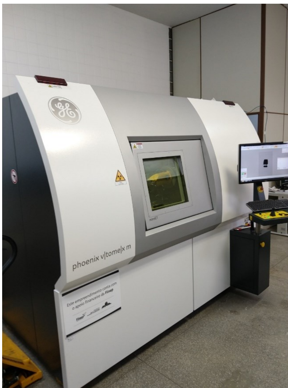
Figura 3.18 – Microtomógrafo modelo Phoenix V|tome|x m do Laboratório de Instrumentação Nuclear da UFRJ.
