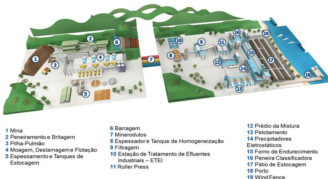
Figura 3.2. Processo produtivo da Samarco Mineração S/A (SAMARCO, 2015).
