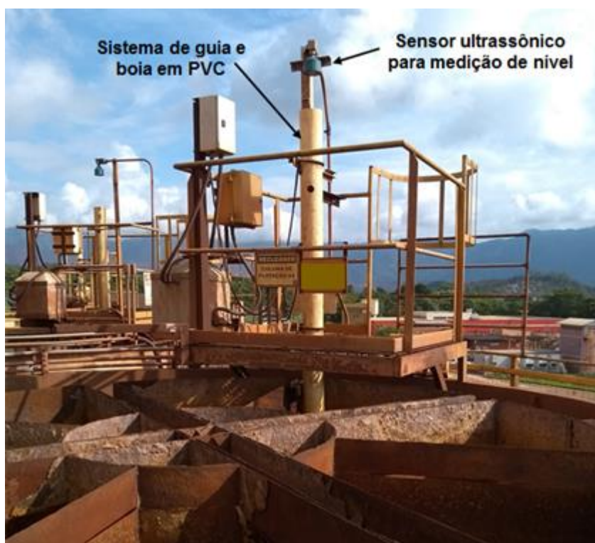
Figura 5.1. Sistema utilizado pela Samarco para medição de nível da interface polpa/espuma em colunas de flotação.
