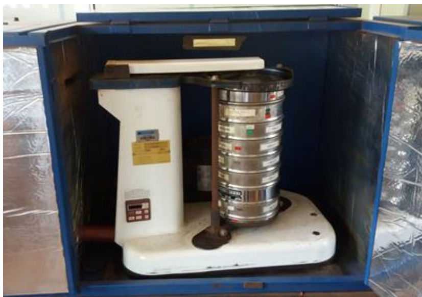
Figura 5.4. Equipamentos para análise granulométrica: peneiras da série Tyler e agitador eletromagnético.
