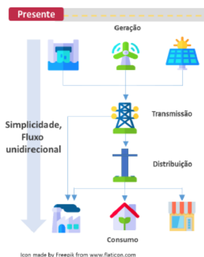
Figura 1: Sistema elétrico de energia, rede convencional. (Fonte: EPE, 2018 / BRANDÃO 2019 – Adaptada).
