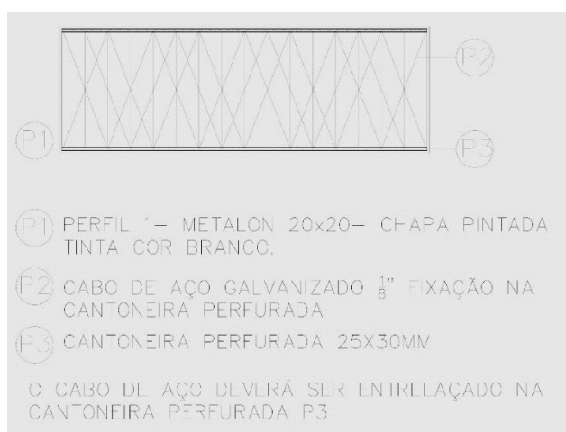
FIGURA 40 - DETALHAMENTO DO GUARDA CORPO
