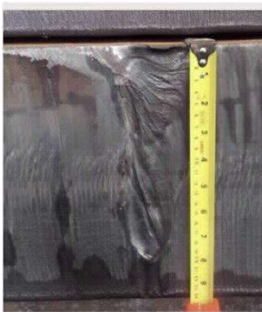
Figura 3.6– Foto da face relacionada à espessura da placa indicando o defeito causado por corte irregular.
