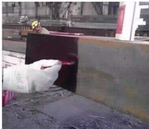
Figura 4.14 - Foto ilustrativa da aplicação do líquido penetrante na seção de corte.
