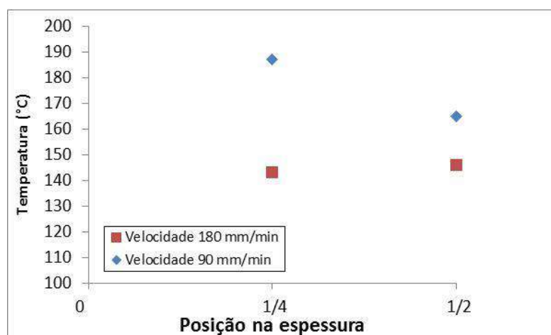
Figura 5.3b – Gráfico de relatório interno Usiminas da diferença das temperaturas máximas obtidas nas posições dos termopares a \frac{1}{2} e \frac{1}{4} da espessura da placa cortada via velocidades de avanço de oxicorte a 180 e 90 mm/min, posição dos termopares a 50 mm da superfície de corte.
