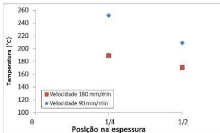
Figura 5.3a – Gráfico de relatório interno Usiminas da diferença das temperaturas máximas obtidas nas posições dos termopares a \frac{1}{2} e \frac{1}{4} da espessura da placa cortada via velocidades de avanço de oxicorte a 180 e 90 mm/min, posição dos termopares a 25 mm da superfície de corte.
