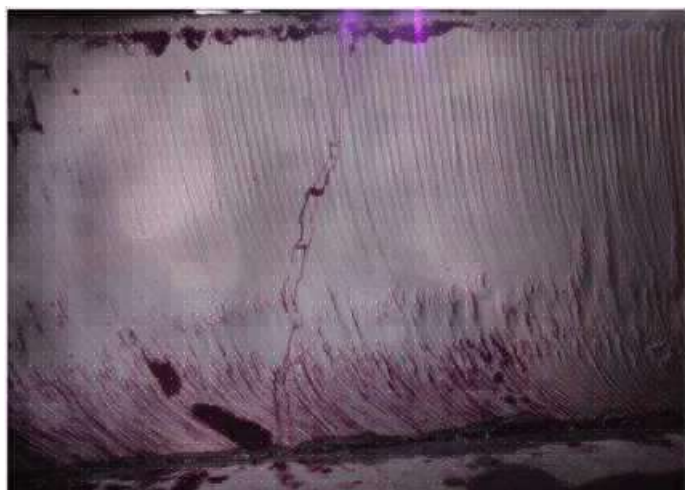
Figura 3.8 - Foto de trinca transversal ao comprimento da placa na seção de corte.
