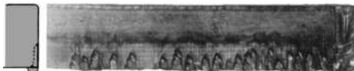
Figura 3.5b - Efeito da baixa velocidade de oxicorte no acabamento da face cortada por oxicorte (ESAB, 2019). A superfície apresenta aberturas ou sucos na parte inferior da peça cortada aliado a presença de escória na peça.
