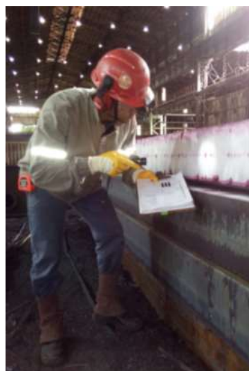
Figura 4.17 – Foto da inspeção visual de placas após aplicação do líquido revelador.
