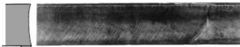
Figura 3.5c - Efeito da alta velocidade de oxicorte no acabamento da face cortada por oxicorte (ESAB, 2019). A superfície de corte apresenta-se encurvada com as linhas do “kerf” em forma de curvas e paralelas, além da presença de escória na peça.
