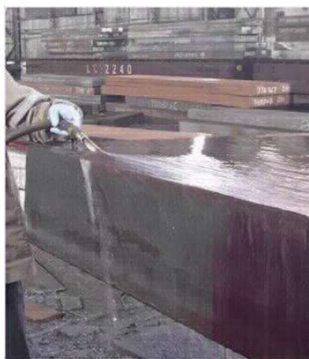
Figura 4.15 – Foto ilustrativa da remoção do líquido penetrante aquoso lavável.
