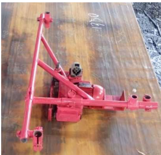
Figura 4.4 – Foto interna Usiminas Ipatinga do suporte para maçaricos e máquina de oxicorte portátil.
