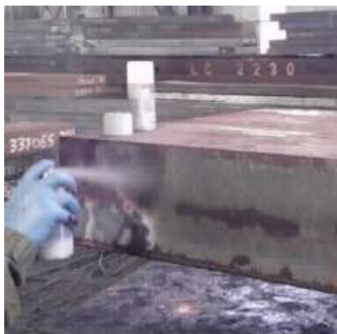
Figura 4.16 – Foto ilustrativa da aplicação do líquido revelador.
