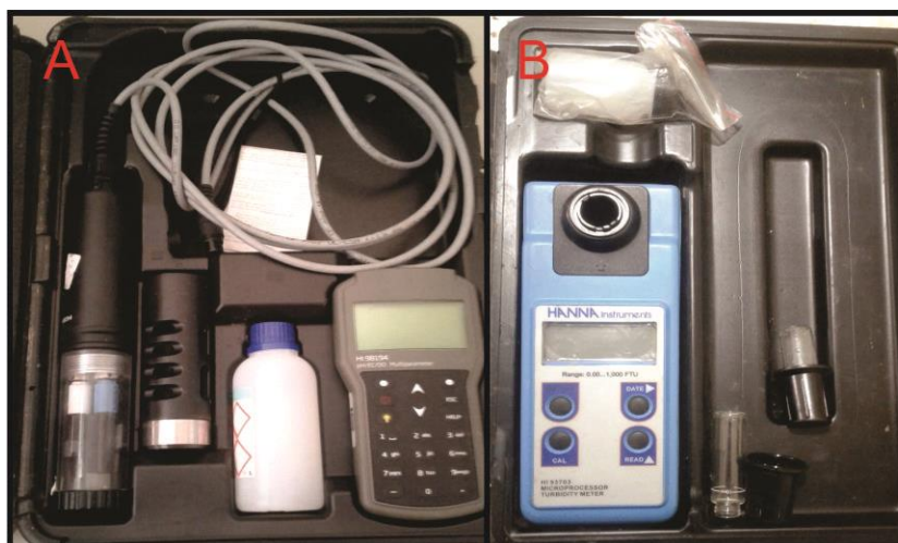
Figura 15 - Instrumentos usados na análise da água. A) Analisador de Multiparâmetros Hanna HI98194; B) Turbidímetro Hanna HI93703.
