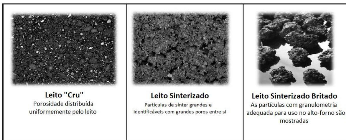
Figura 3. 1 – Estrutura do leito de sinterização antes e após a sinterização (adaptado de Loo et. al., 2012).
