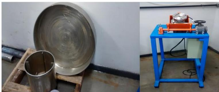
**Figura 4.2** – Tambor, disco e sistema de controle de parâmetros dos equipamentos a serem utilizados na aglomeração a frio
