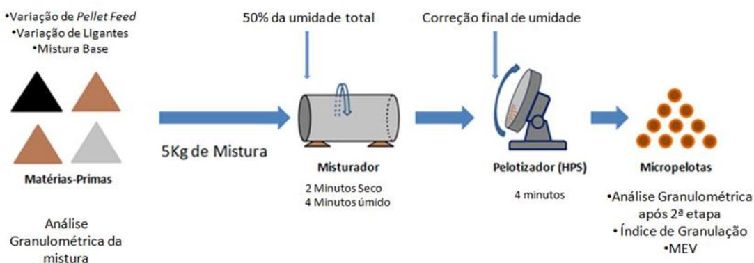
Figura 4. 5 – Esquema simplificado dos testes de aglomeração a frio
