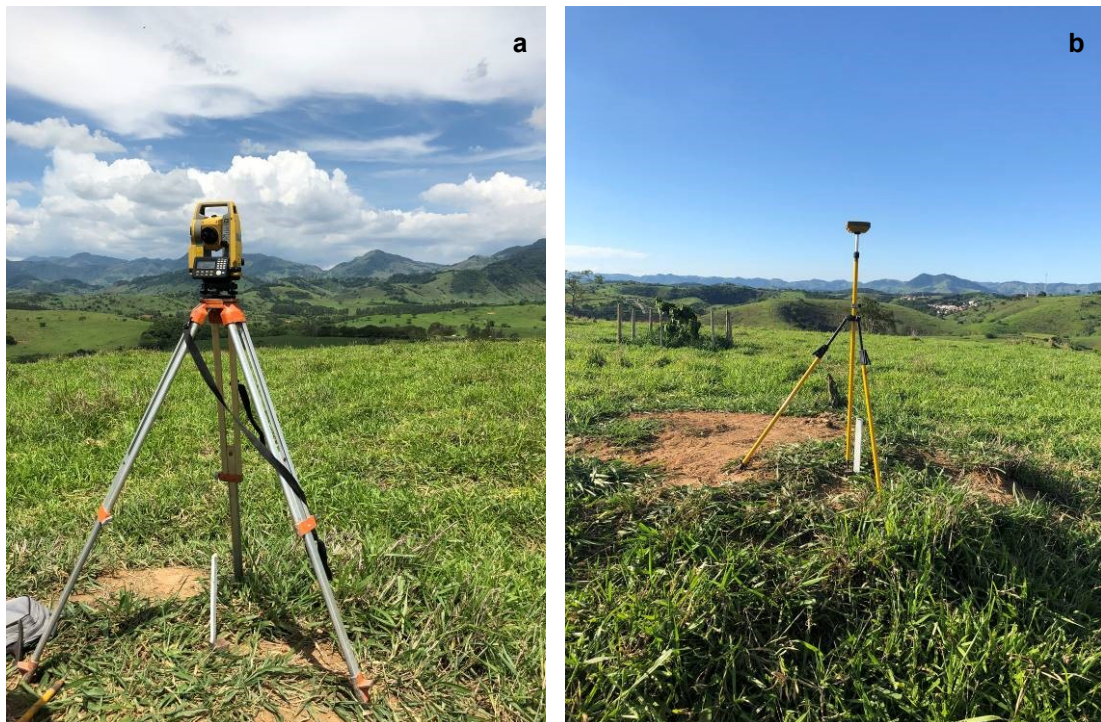
Figura 21: Estação total (a) e receptor geodésico (b) utilizados no levantamento topográfico.
