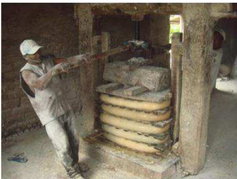
Figura 69 - Produção de farinha de mandioca pelo sistema manual Comunidade de Campinhos – Vitória da Conquista-BA
