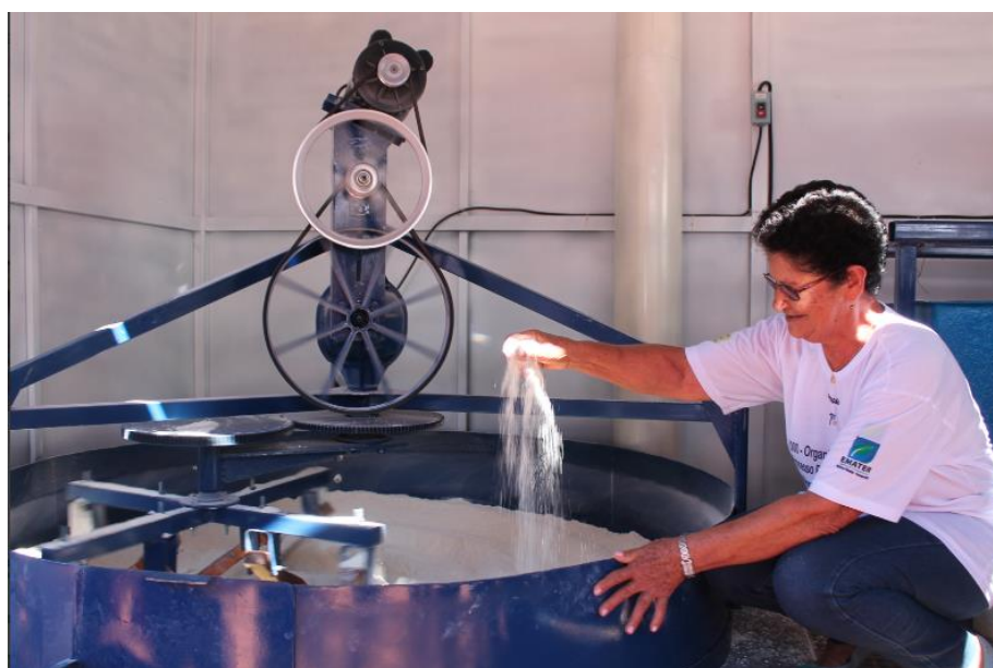
Figura 28 - Trabalho no forno rotativo da casa de farinha móvel
