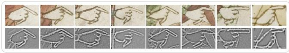
Figura 3 - Conjunto de templates para o gesto de apontar que ajuda a alimentar o algoritmo de detecção de gestos.
