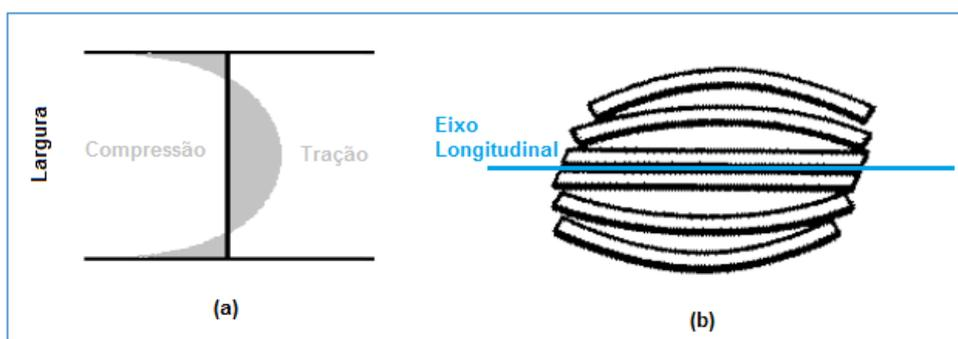
Figura 3.20 – Perfil da distribuição de tensões internas em uma chapa e curvatura das tiras após o corte longitudinal.
