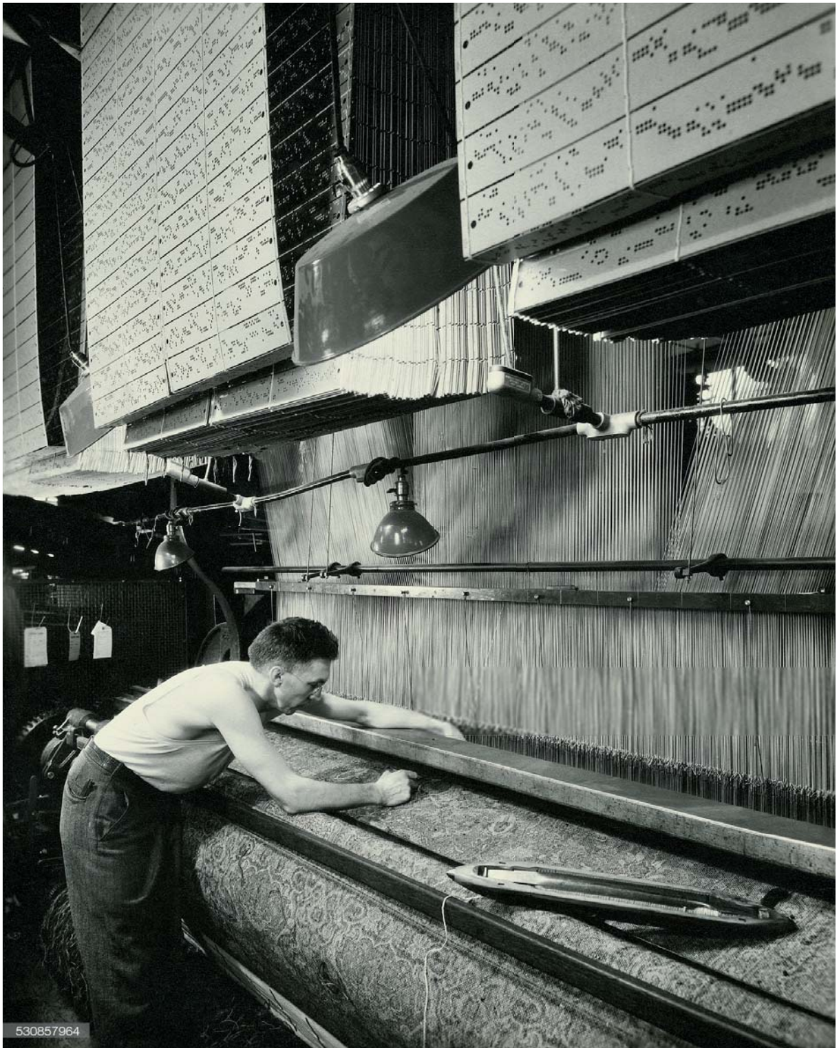
Figura 2.4 Máquina de Jacquard - sistema de cartões perfurados para teares. (c. 1920)
