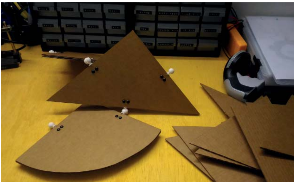
Figura II.7 Protótipo de peças com conectores rotulares para o sistema Open Clark #1 Imagem: acervo pessoal
