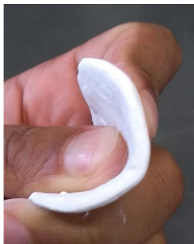
Figura 7.2 – Fotografia da amostra VB10-PCL10 evidenciando sua ductilidade.
