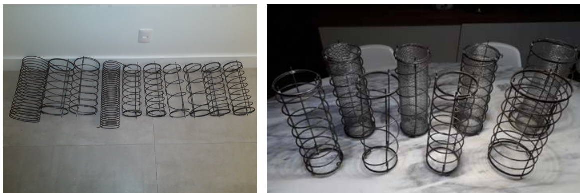
Figura 4.3 - Armaduras em Hélice - Cintamentos dos Ensaio de Luva
