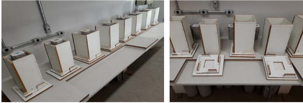
Figura 4.11 - Moldes Quadrados em MDF dos EL - 15x15 x 37,5cm (os dois à esquerda, nas duas fotos) e 20x20 x 37,5cm.
