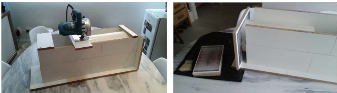
Figura 4.7 - Equipamento para Corte e Lixamento de Tubo de PVC de 200mm
