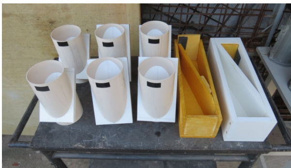
Figura 4.12 - Moldes do ECI - \phi 9,6 x 20cm (45°, 52,5° e 60°) e 9 x 8,7 x 34,6cm (75°) - para o concreto velho (foto esq.) e para o concreto novo (foto dir.).
