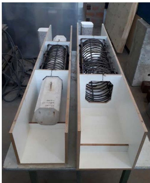
Figura 4.14 - Formas para o Concreto Novo (Graute) dos Modelos Recuperados dos EP.
