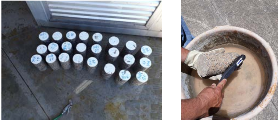
Figura 7.7 - Lavagem após ataque ácido e escovação para retirada da argamassa desagregada
