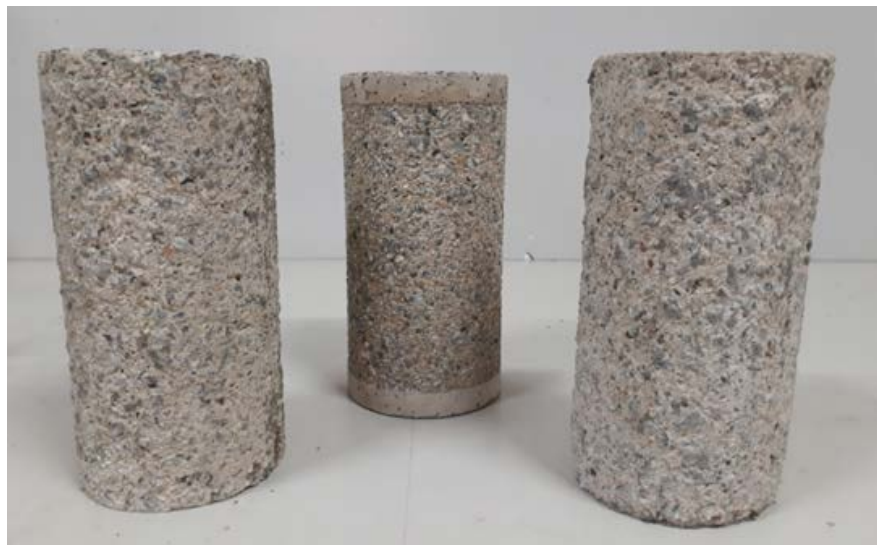
30/00 20/00 20/00 Figura 7.9 - CPs de Brita 00 Após o Apicoamento Químico. No centro, CP 20/00 com faixas de referencia sem apicoamento.
