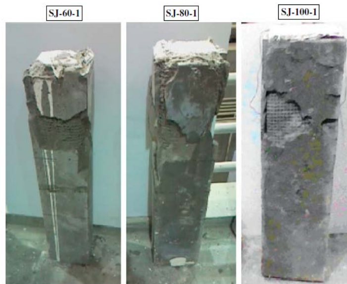
Figura 2.40 - Modo de Falha Típica dos Espécimes Reforçados Com Pré-Carregamento
