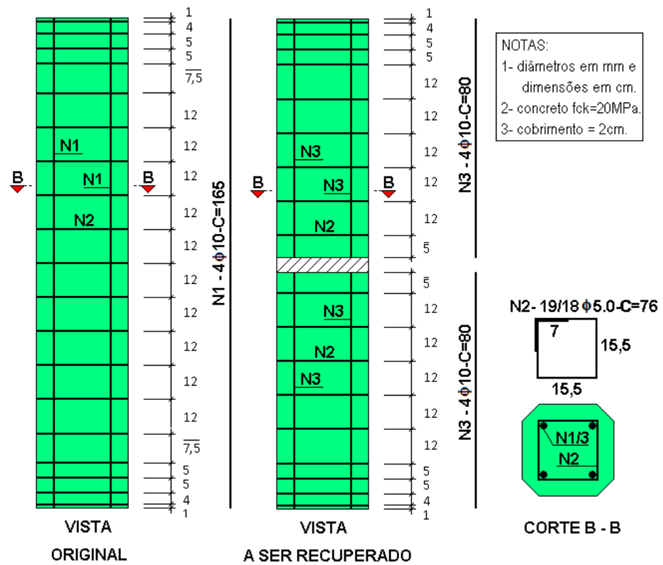
Figura 11.5 - Pilar Original - Modelo 15x15 - Armação
