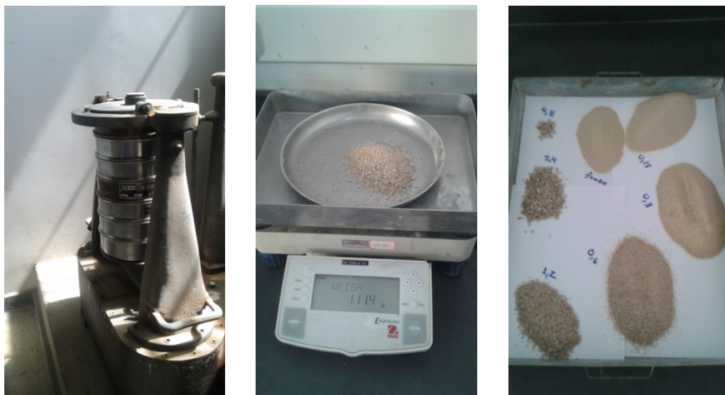
Figura 4.1 - Procedimentos para Determinação do Módulo de Finura das Areias.
