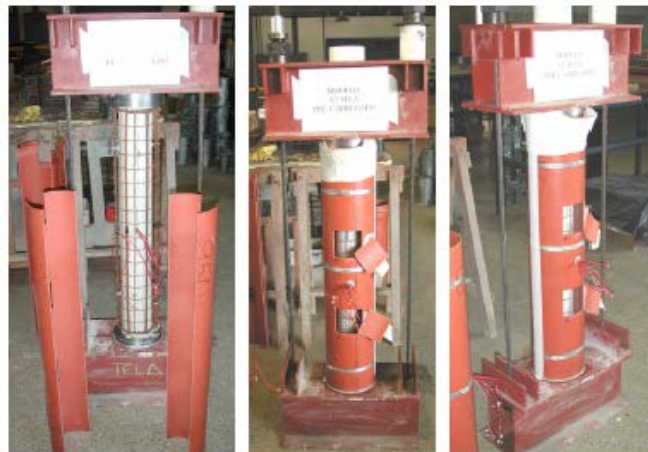
Figura 2.25 - Fôrma para Concretagem das Camisas de Reforço dos Modelos com Pré-Carregamento e Seção Transversal Circular
