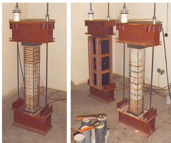
Figura 2.23 - Montagem das Armaduras de Reforço dos Modelos a Serem Pré-Carregados
