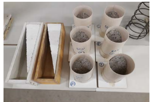
Figura 4.12 - Moldes do ECI - \phi 9,6 x 20cm (45°, 52,5° e 60°) e 9 x 8,7 x 34,6cm (75°) - para o concreto velho (foto esq.) e para o concreto novo (foto dir.).
