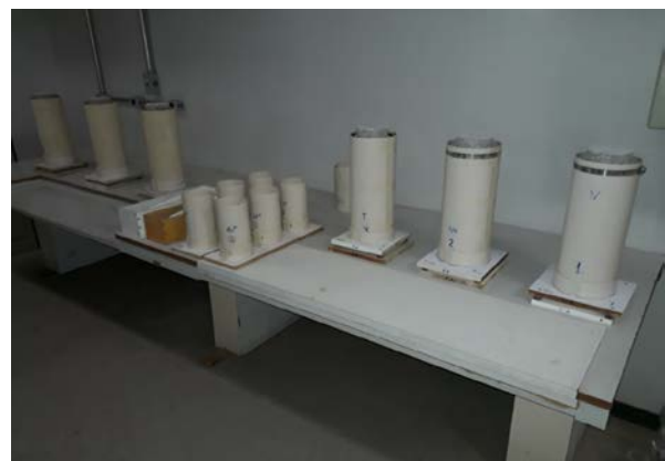
Figura 4.10 - Moldes PVC \phi 19,2 \times 38 cm do EL (foto esq.) e \phi 14,4 \times 38 cm do EL (foto dir.). No centro (foto dir.), moldes do concreto novo do ECI.
