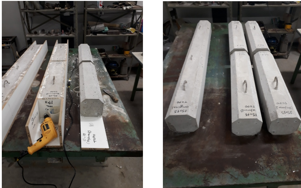
Figura 13.4 - Desforma - Pilar Original e Pilaretes dos Pilares-Recuperados.
