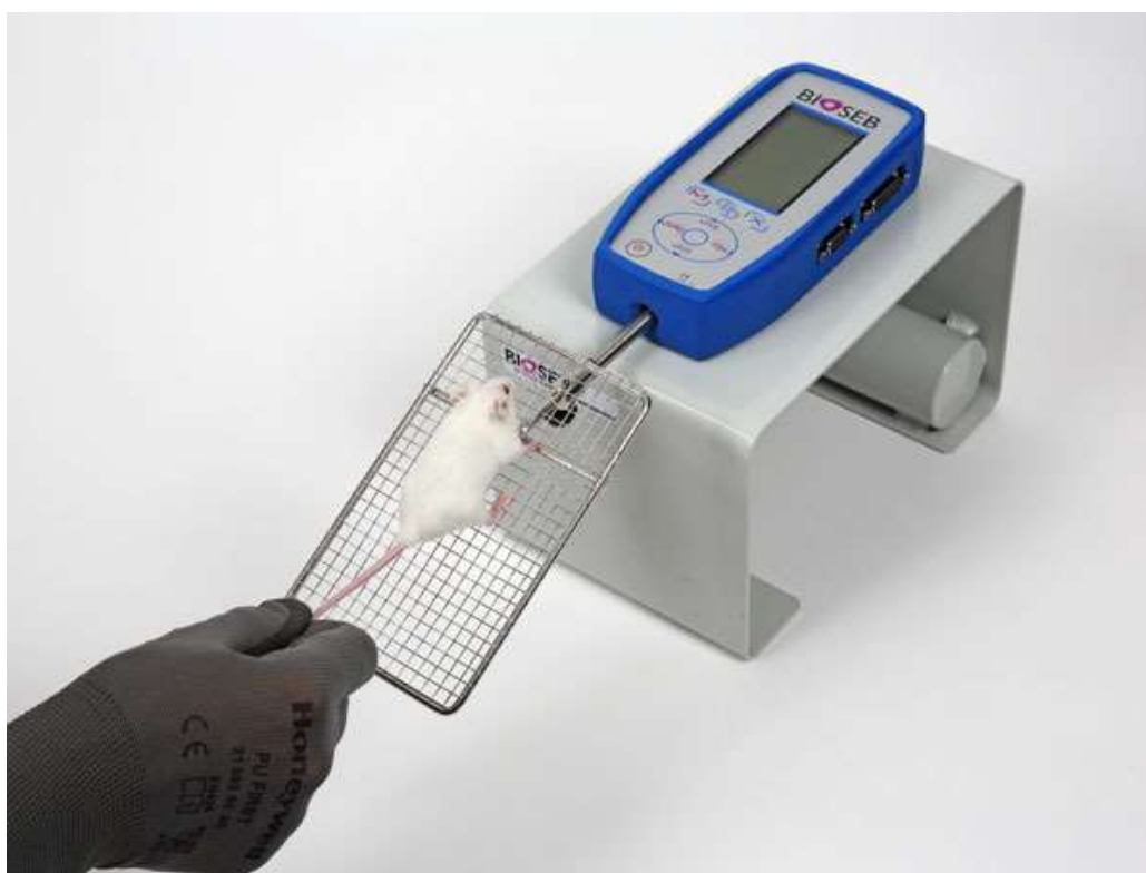
Figura 10: Teste de força de agarre. Aparelho utilizado para medir objetivamente a força de agarre determinando o pico de força máxima desenvolvida por roedores. A medição é realizada usando um transdutor de força e um dispositivo eletrônico oferecendo uma taxa de amostragem de 1000 Hz. Isto assegura que a força máxima é perfeitamente capturada ( http://www.bioseb.com/bioseb/anglais/default/item_id=48.php ).
