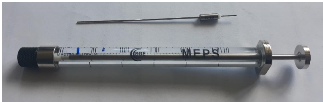
Figura 21 - Seringa e cartucho utilizados para microextração em sorvente empacotado.
