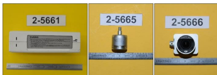
Figura 3-7: Componentes de RPA Utilizados em Testes Balísticos – Bateria (à Esquerda), Motor (Centro) e Câmera (à Direita). Retirado de Olivares et al. (2017a)
