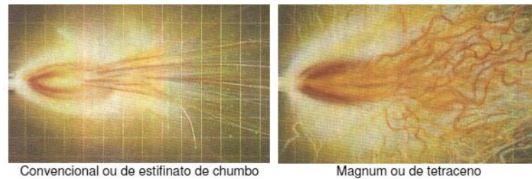
Figura 25 - Chamas produzidas por espoletas Fonte: Polícia Federal (2017)
