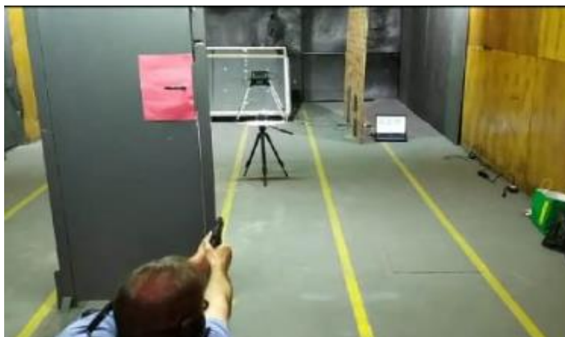
Figura 69 - Posição do atirador profissional durante o disparo de teste, protegido por anteparo.
