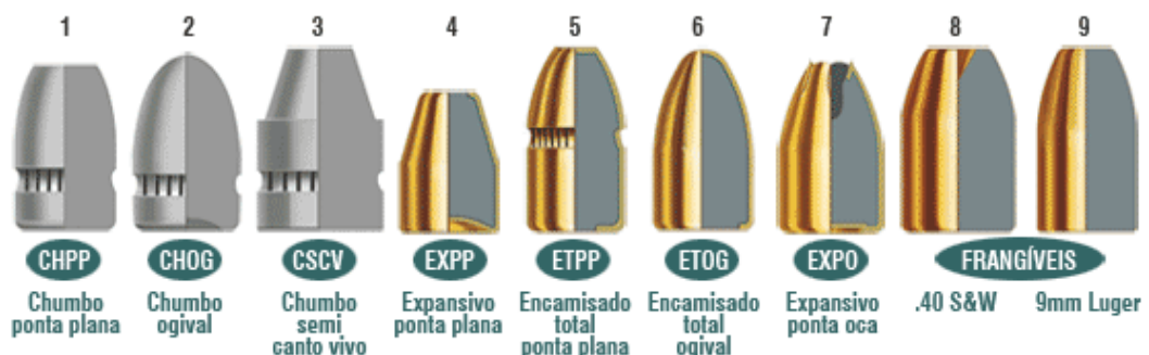
Figura 44 - Alguns tipos de pontas para as mais variadas finalidades específicas. Fonte: Polícia Federal (2017)
