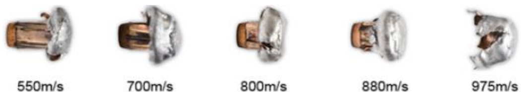
Figura 42 - Expansão de um projétil de acordo com as velocidades de impacto. Fonte: Polícia Federal (2017)
