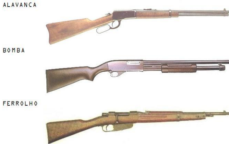
Figura 16 - Exemplo de armas de funcionamento não automático Fonte: Carvalho (2010).
