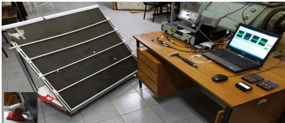
Figura 64 - Bancada de vibração com para o teste de martelo de impacto.
