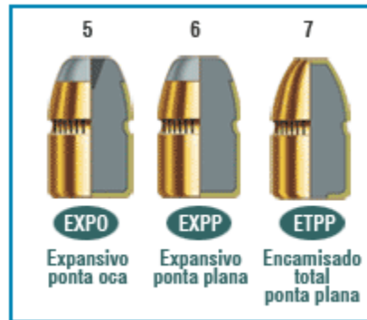
Figura 41 - Projéteis expansivos Fonte: CBC, 2019
