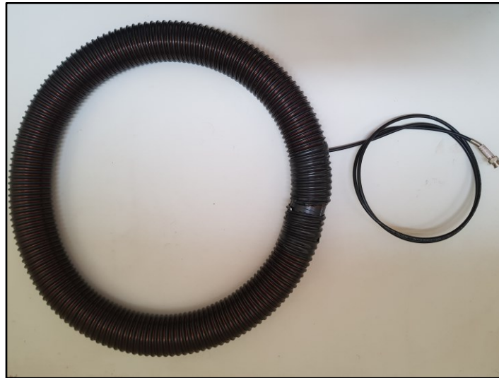
Figura 3.20 – Bobina de Rogowski construída manualmente.
