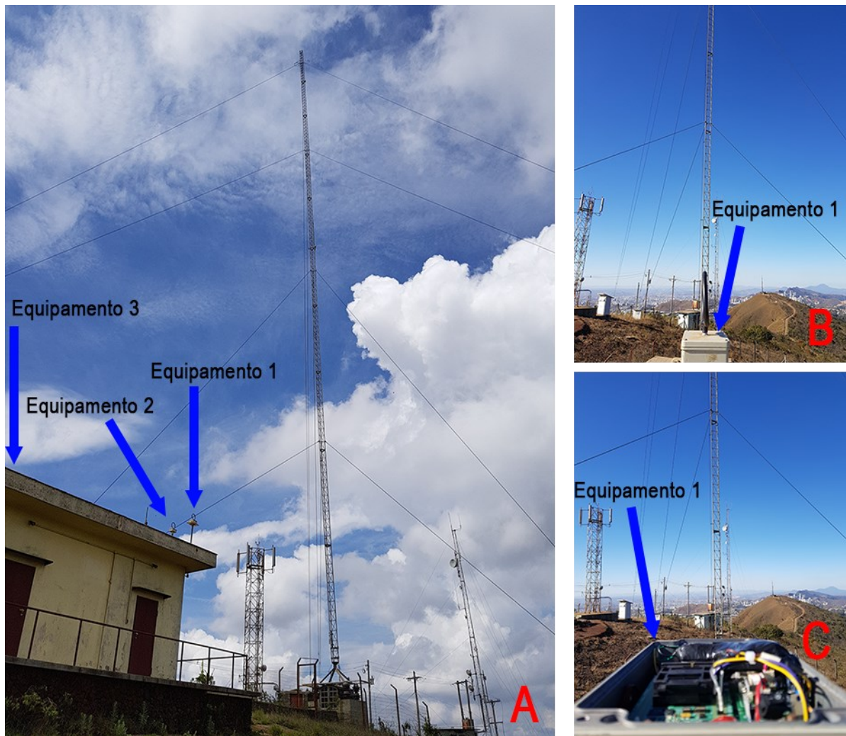
Figura 4.18 – Dispositivos com antena loop instalados na estação de pesquisa MCS. (A) Vista geral. (B) Posicionamento da antena do equipamento 1. (C) Componentes internos referente ao equipamento 1.
