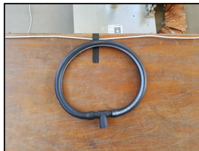
Figura 3.30 – Experimento para avaliar o desempenho da antena.
