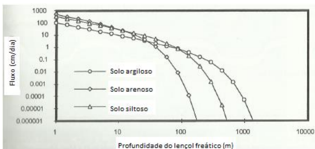
Figura 8.2 - Diferenças de K em relação à profundidade da zona saturada com o tipo de solo.
