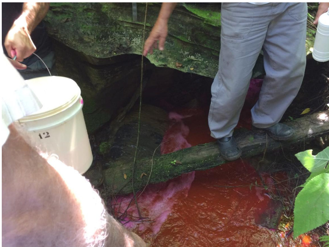
Foto 4.2 – Injeção de rodamina em sumidouro.
