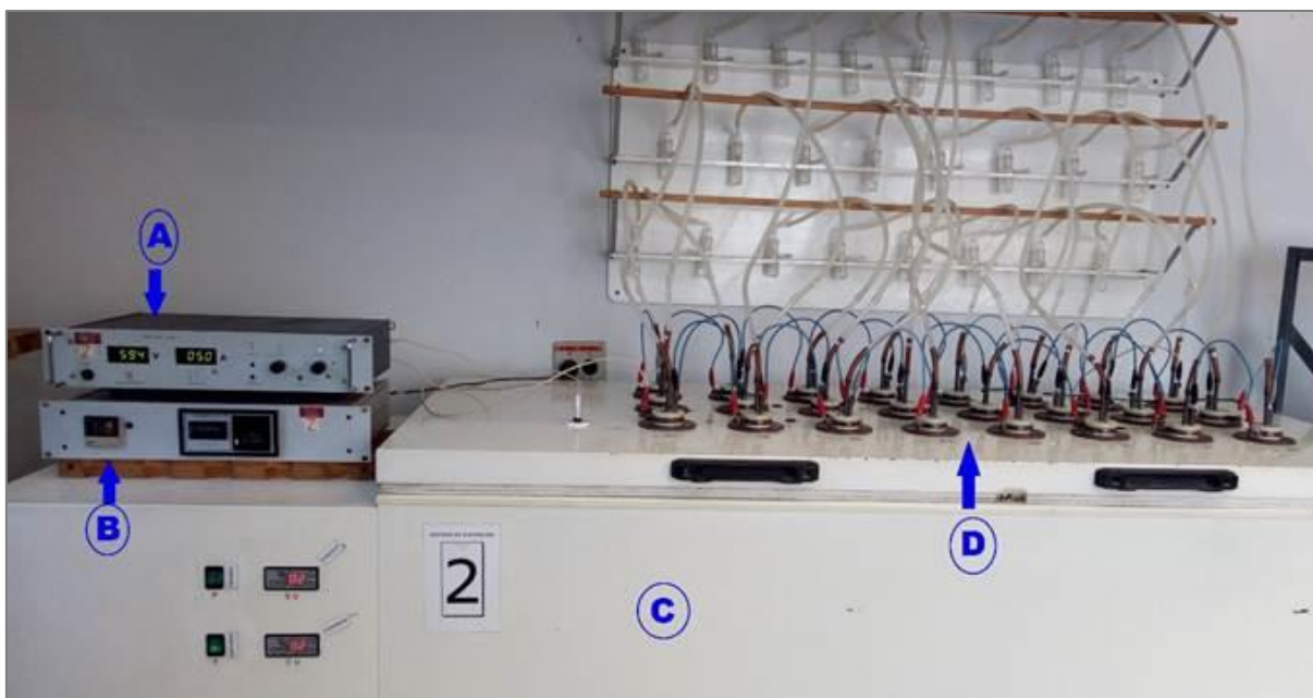
Figura 4.6 – Sistema Rozanski no Laboratório de Trítio Ambiental no CDTN com uma fonte de corrente contínua (A), um integrador de corrente (B), um freezer (C) e as células eletrolíticas (D) que são acopladas durante a etapa de enriquecimento eletrolítico
