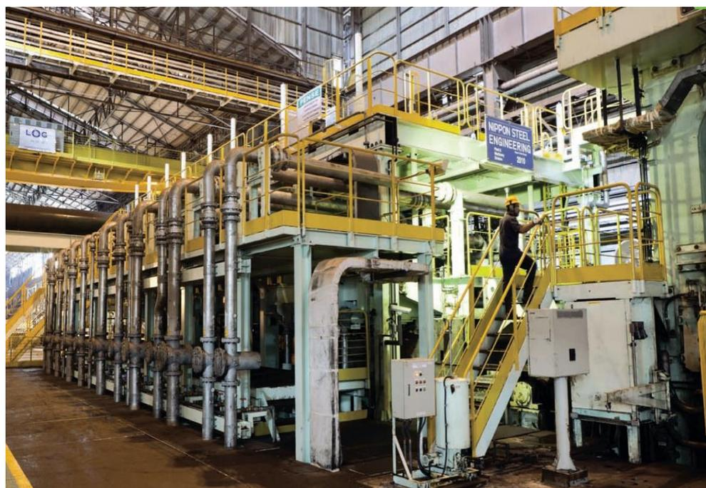
Figura 3.6 Equipamento de resfriamento acelerado da Usiminas.
