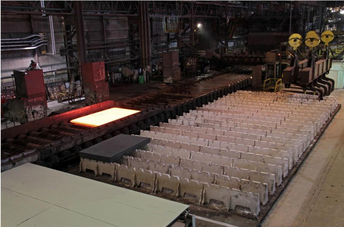
Figura 4.6 Resfriamento do material para segundo estágio de laminação.
