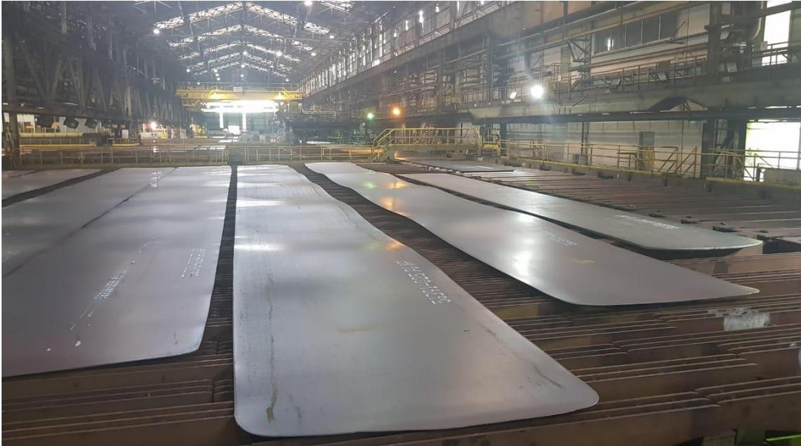
Figura 3.14 Material com anormalidade de planicidade, defeito ondulações (fonte Usiminas).
