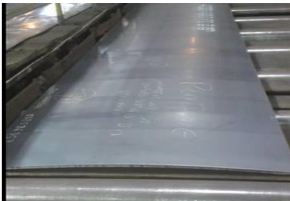
Figura 3.13 Material com anormalidade de planicidade, defeito convexidade (fonte Usiminas).
