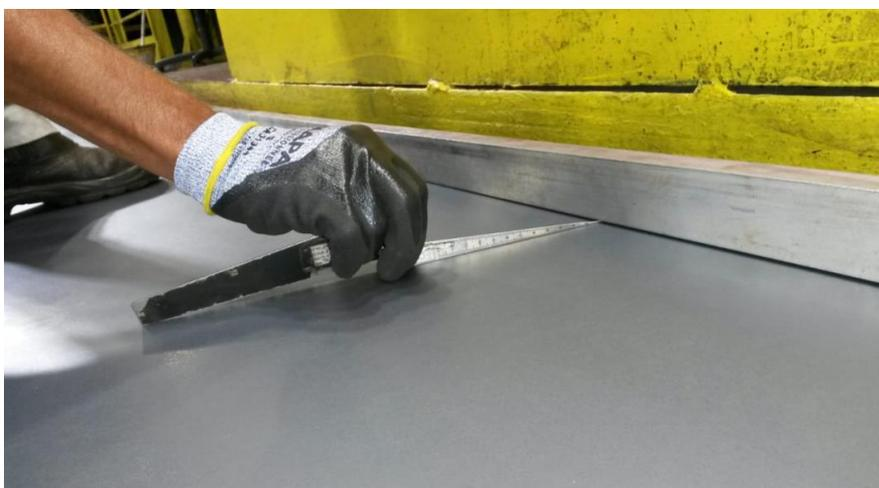
Figura 4.8 Medição de planicidade em chapas grossas com uso de régua e cunha.
