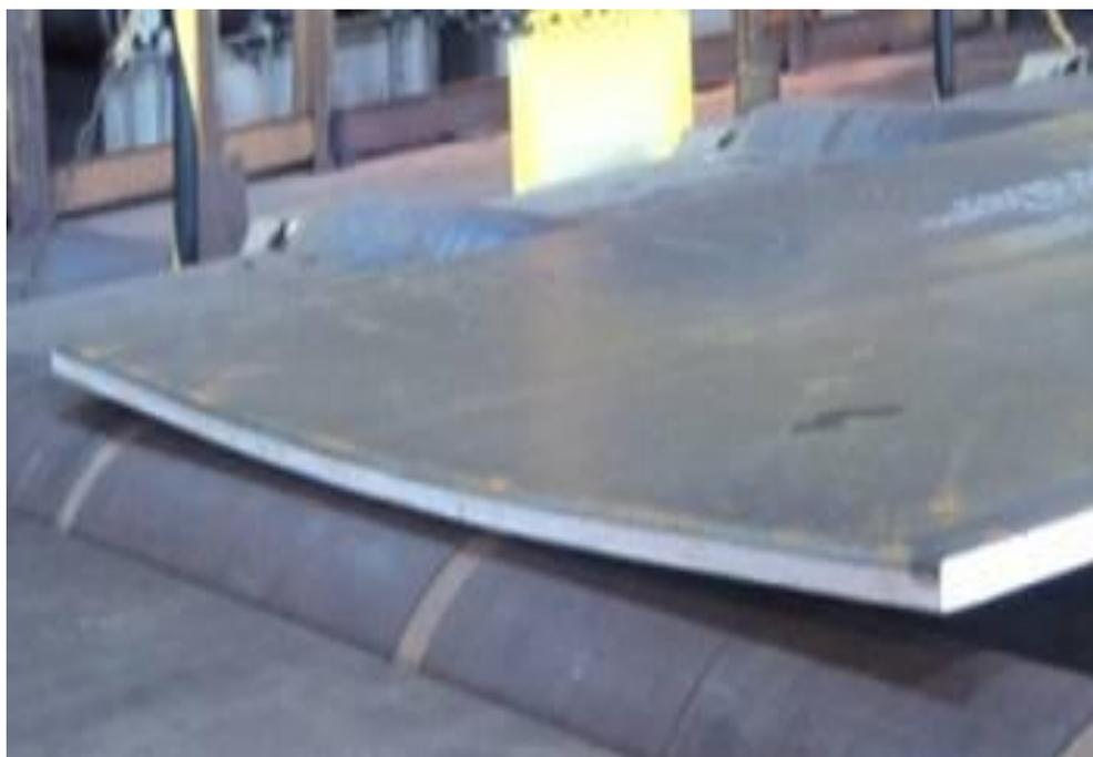
Figura 3.12 Material com anormalidade de planicidade, defeito concavidade.(fonte Usiminas).
