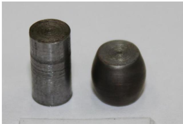
Figura 5.3 Fotografia do CP após ensaio de dilatometria com deformação
