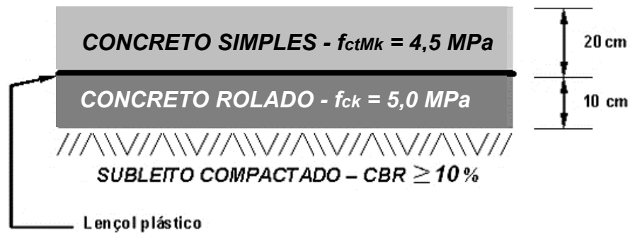
Figura 4.2 - Solução de pavimento rígido de concreto no anteprojeto de engenharia Fonte: Disponibilizado pelo órgão público (2019)
