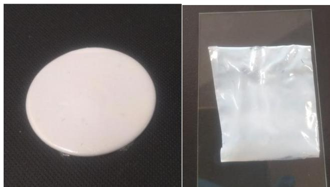
**Figura 26** - Membrana composta de filme de grafeno/PMMA: a) GRAFENO\_PMMA\_996kDa\_CB\_6 (à esquerda) e b) GRAFENO\_PMMA\_996kDa\_Ac\_15 (à direita).
