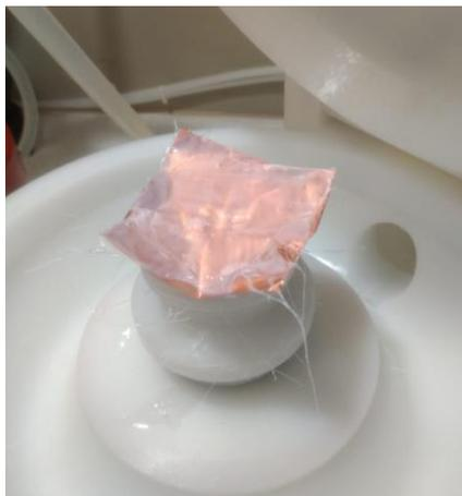
**Figura 15-** Filme não coeso formado pela solução de PMMA\_996kDa\_AC\_15 em *spin coater*.
