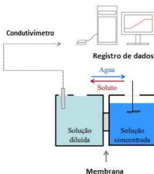
**Figura 5-** Representação do sistema de permeação de osmose direta.
