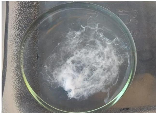
**Figura 19** - Traço de nuvens em sistema PMMA-Clorobenzeno-Etanol a 25°C e umidade relativa de 70%.
