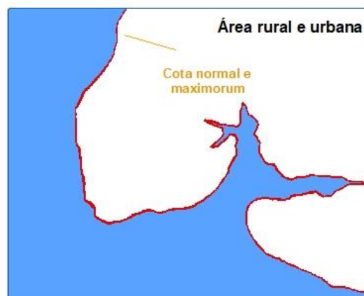
Figura 5 - Figura representativa dos limites da APP de lagos e reservatórios para áreas rurais e urbanas de acordo com a Lei Federal 12.651/2012
