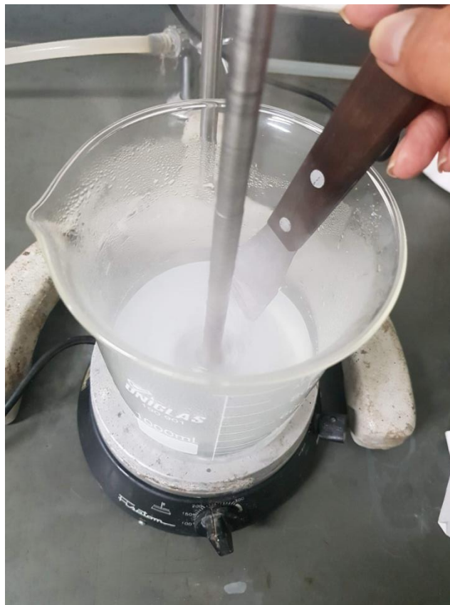
Figura 4.10 – Da esquerda para a direita: PEG (1); Copo Béquer de 50 e 1000 ml (2,3); Espátula para pesagem do PEG (4); Hélice naval (5); Espátula auxiliar (6).
