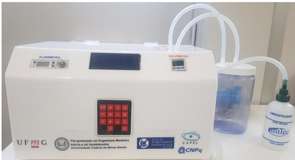
Figura 2.3 – Protótipo do novo aspirador de secreções pulmonares desenvolvido por LAS-CASAS (2018).
