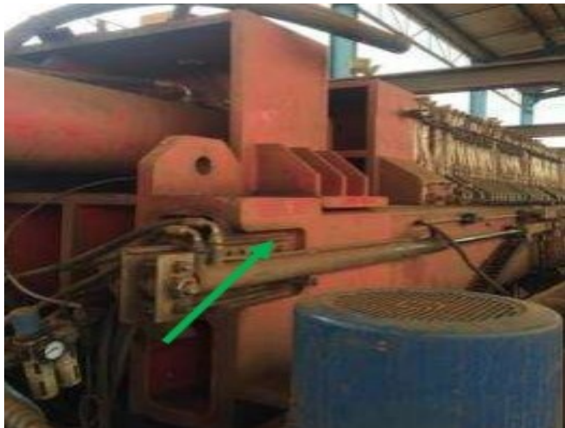
Figura 14 – Solda de Ligação das Chapas Laterais – Lado Cilindro.
