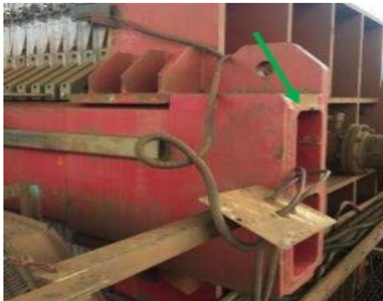
Figura 15 – Solda de Ligação das Chapas Laterais – Lado Alimentação
