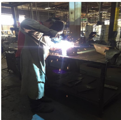
Figura 11: Soldador executando o Welding Blind Test
