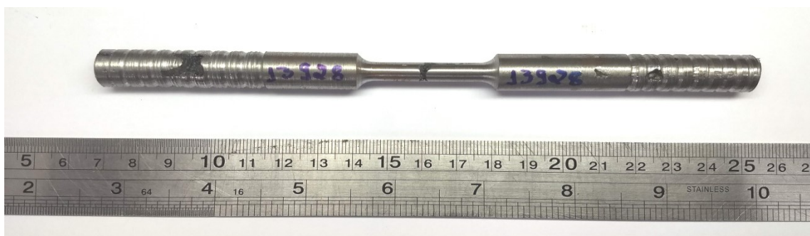
Figura 18: Corpo de prova nº1 - Detalhe para as descontinuidades (região central e extremidades)
