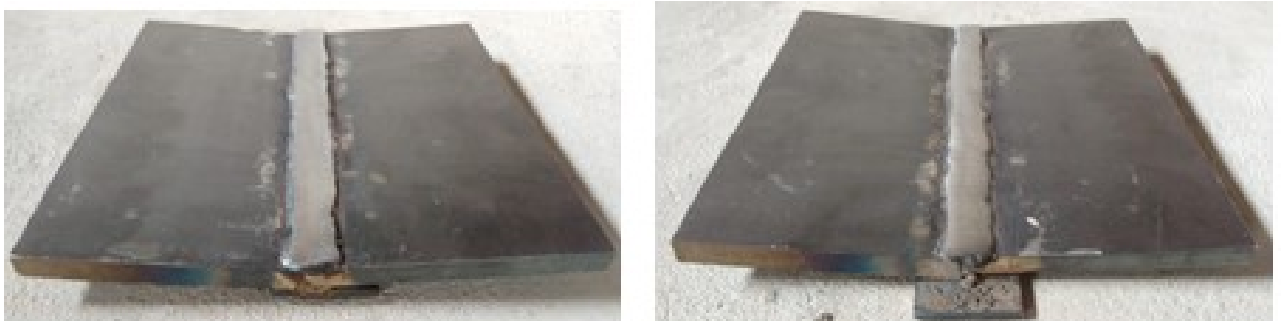
Figura 15: Corpos de prova soldados conforme especificação AWS 5.1
