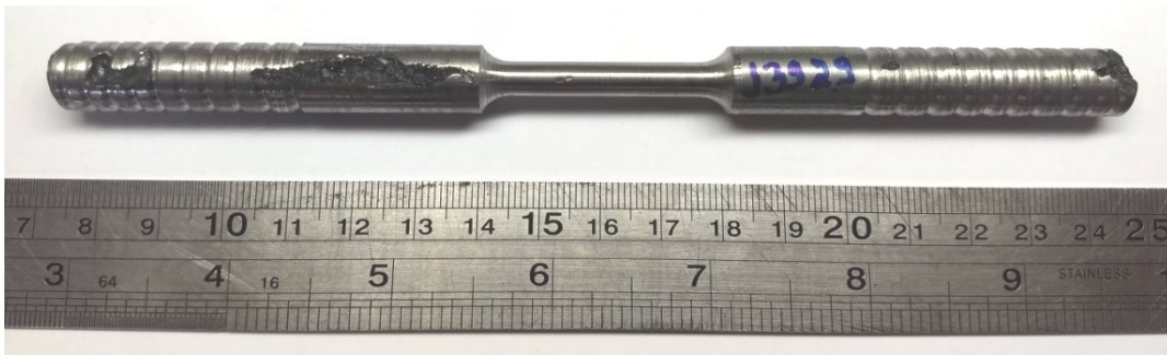
Figura 20: Corpo de prova n°2 - Detalhe para as discontinuidades (extremidades)
