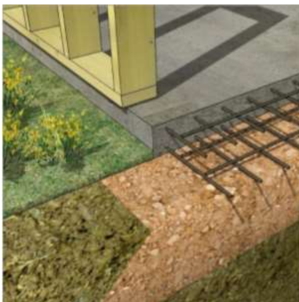
Figura 3 – Fundação em Radier para parede em wood frame
