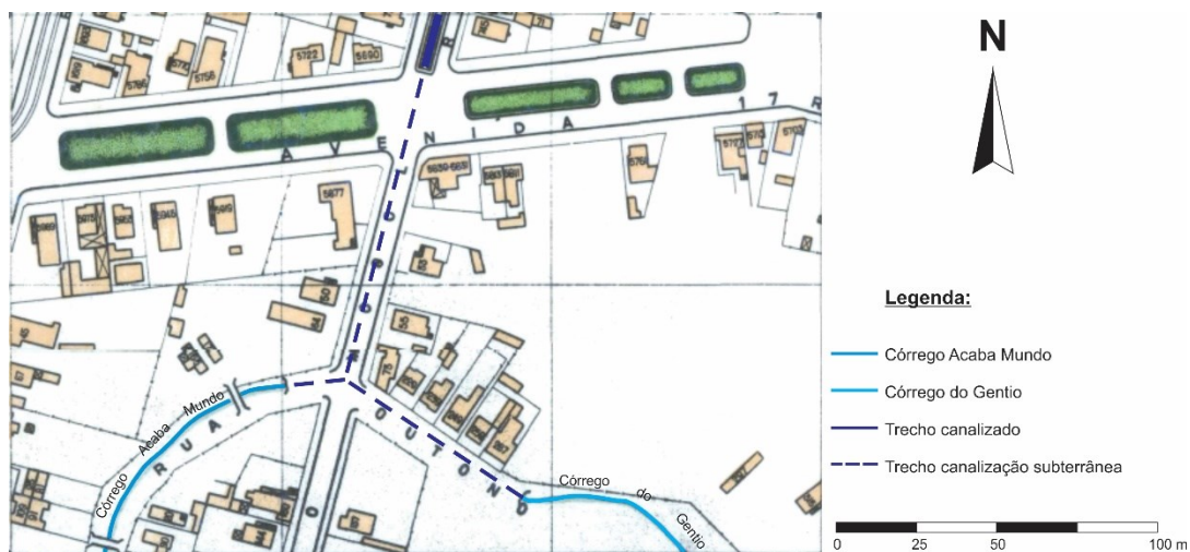
Figura 80 – Trecho de canalização dos córregos Acaba Mundo (à esquerda) e Gentio (à direita), na zona suburbana, no cruzamento das ruas Outono e Grão Mogol, em 1942.
