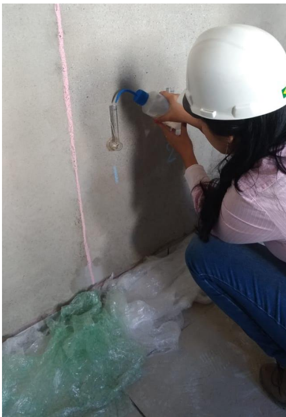
Figura 17 - Enchimento do tubo de Karsten com auxílio da pisseta.
