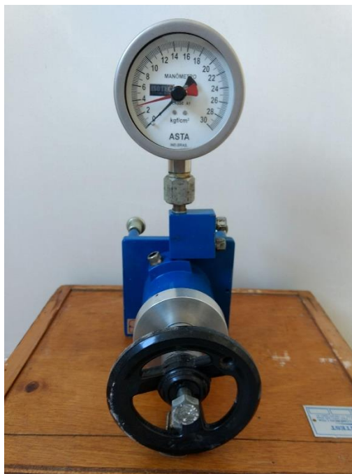
Figura 22 - Equipamento utilizado para o teste de arrancamento.
