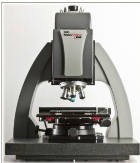
Figura 18 - Perfilômetro óptico 3D (NewView 7300, Zygo Corporation, Connecticut, EUA)
