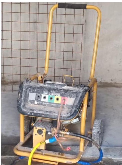
Figura 10 - Lavadora de alta pressão utilizada nos tratamentos superficiais.
