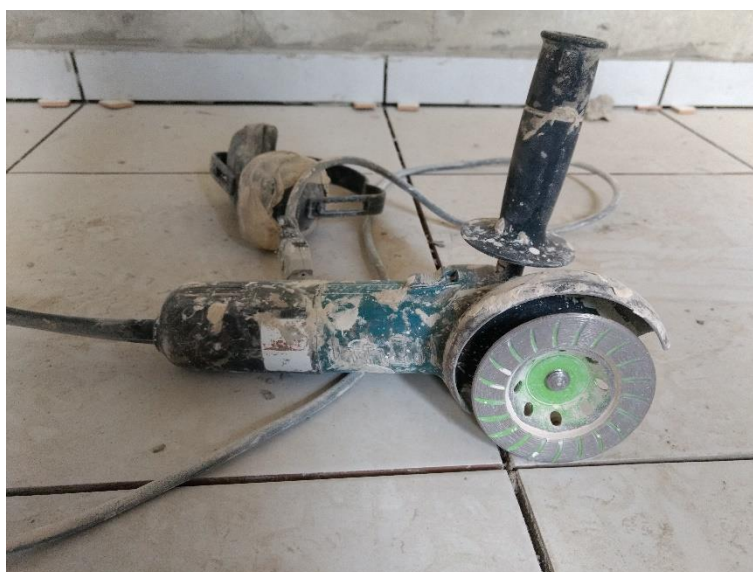
Figura 12 - Lixadeira mecânica com disco rebolo para concreto.
