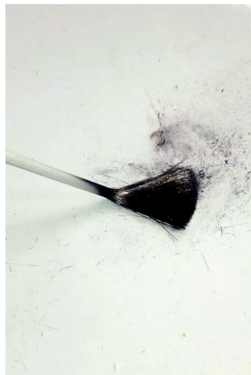
Figura.4- Vareta de fibra com fibras soltas Fonte: Acervo pessoal
