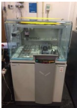
Figura 23 - Equipamento para ensaio de Espectroscopia de Raios X por dispersão em energia.
