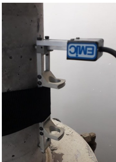
Figura 29 - Extensômetros elétricos para medição de deformação.
