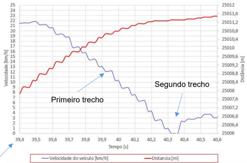
Figura 44 - Distância de parada com freio normal, transmissão acoplada, veículo vazio com 30% da velocidade máxima.
