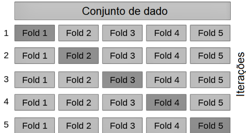
Figura 5.5: Técnica K-fold cross-validation para um k de 5. Cinza claro: Dado de treino; Cinza escuro: Dado de teste.
