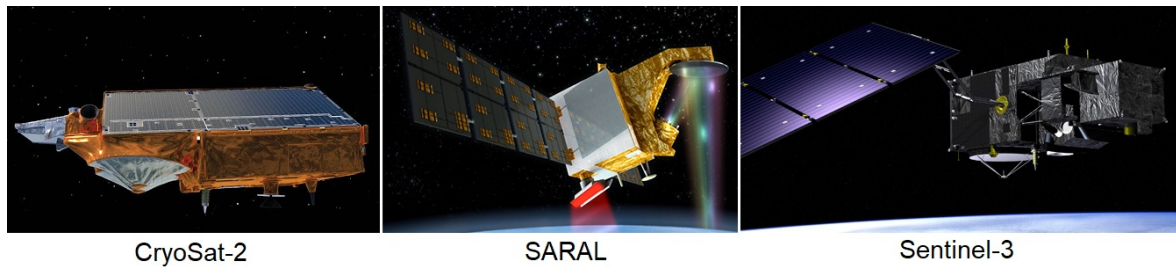
Figura 3.4: Satélites que carregam a bordo os sensores altimétricos SIRAL, AltiKa e SRAL, respectivamente. Imagens disponíveis respectivamente em: https://www.esa.int/ , https://cnes.fr/en , https://sentinel.esa.int/ , Acesso em: 09 mar. 2020.
