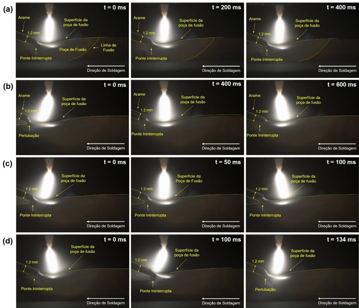
Figura 99: Comportamento do modo de transferência metálica para (a) T1, (b) T2, (c) T3 e (d) T4
