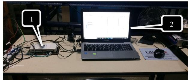
5.32 - Micro de leitura dos valores e placa de aquisição de dados.
