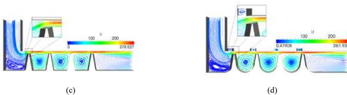
FIGURA 3.11 - Linhas de corrente em labirintos para quatro tipos de geometrias diferentes.
