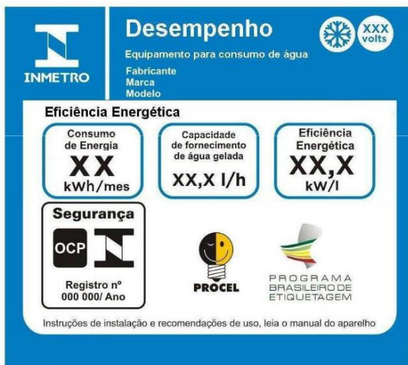
Figura 57 – Selo-modelo para equipamentos elétricos que não realizam funções de melhoria da qualidade da água, contendo apenas informações sobre segurança e consumo de energia elétrica.
