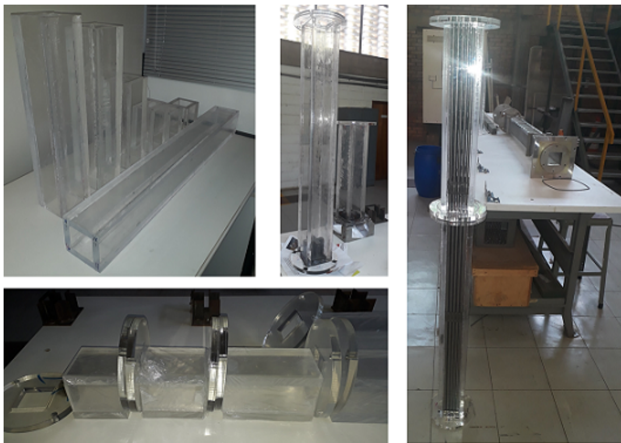
Figura 3.4 – Montagem da Seção de Testes 2.
