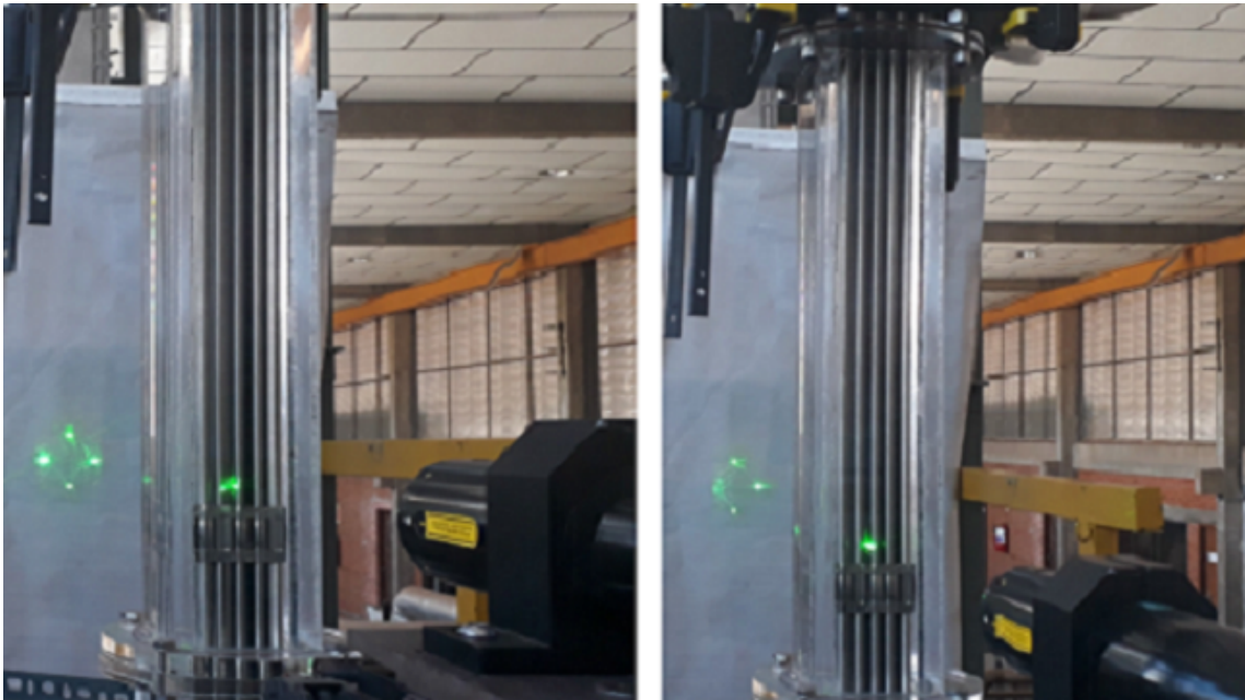
Figura 3.23 – Esquema para representar o centro do subcanal.
