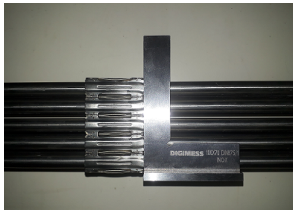
Figura 3.20 – Verificação do alinhamento entre o feixe de varetas e a grade espaçadora.
