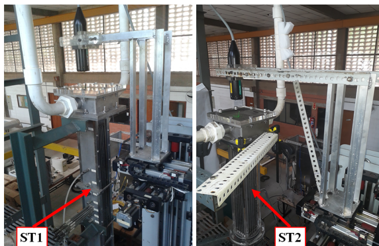
Figura 3.26 – Detalhe do posicionamento do LDV pelo topo das ST1 e ST2
