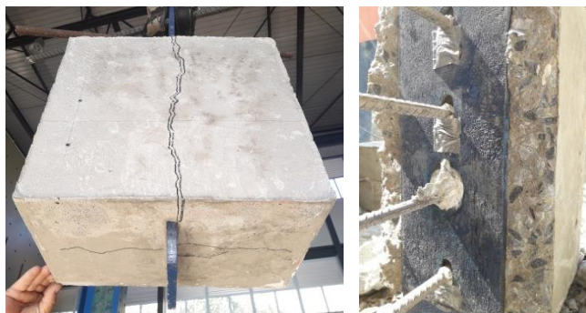
(a) Fissuração do Bloco.
