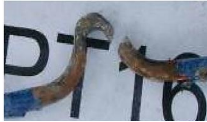
Figura 2.5: Barra rompida após grande deformação plástica (Xiao et al. , 2016).
