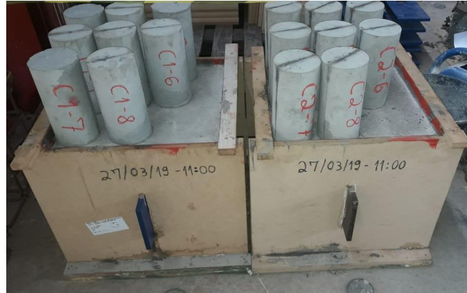
Figura 3.8: Protótipos e corpos de prova concretados simultaneamente, preparados para os ensaios.
