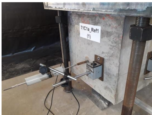
(b) DT para monitoramento do deslizamento da barra.
