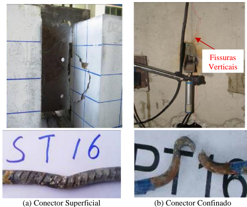
Figura 2.12: Dano na superfície do concreto e deformação da barra transversal ao final dos ensaios (Xiao et al. , 2016). (a) Ensaio padrão: conector superficial; (b) Ensaio tipo plug-in : conector profundo.
