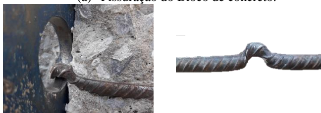
(b) Deformada da barra.
