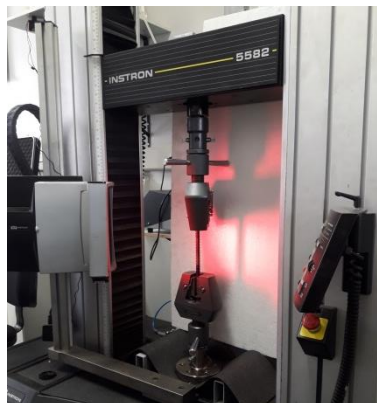
Figura 3.10: Ensaio de tração das barras de aço com medição do alongamento por extensômetro ótico.
