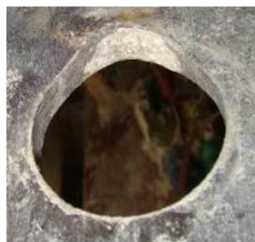
Figura 2.9: Escoamento da chapa na região que entrou em contato com a barra transversal (Xiao et al. , 2016).
