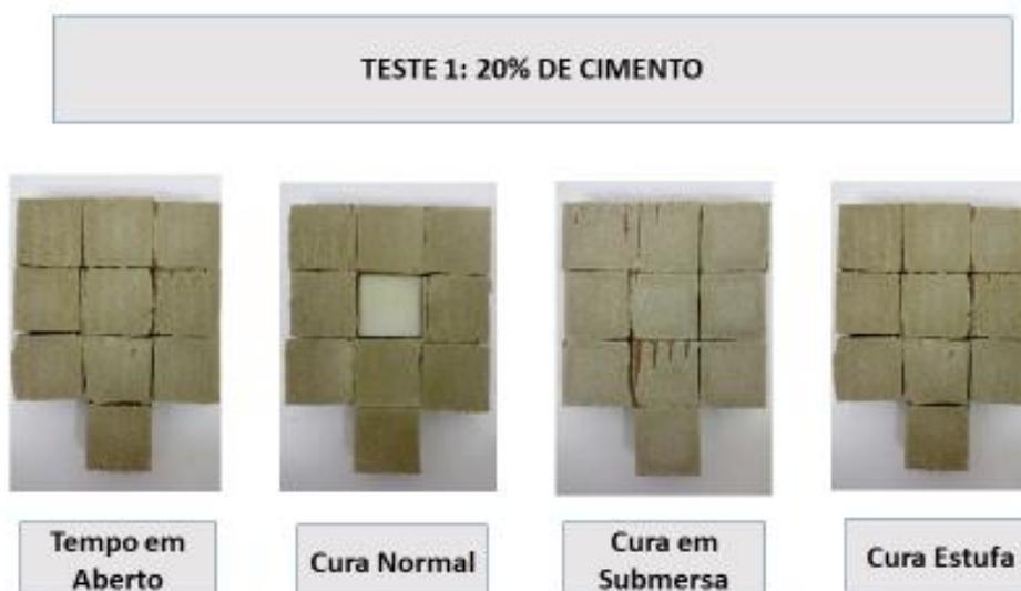
Figura 27 – Apresentação dos pontos de ruptura das amostras com 20% de cimento na repetição dos ensaios de caracterização (Conclusão)
