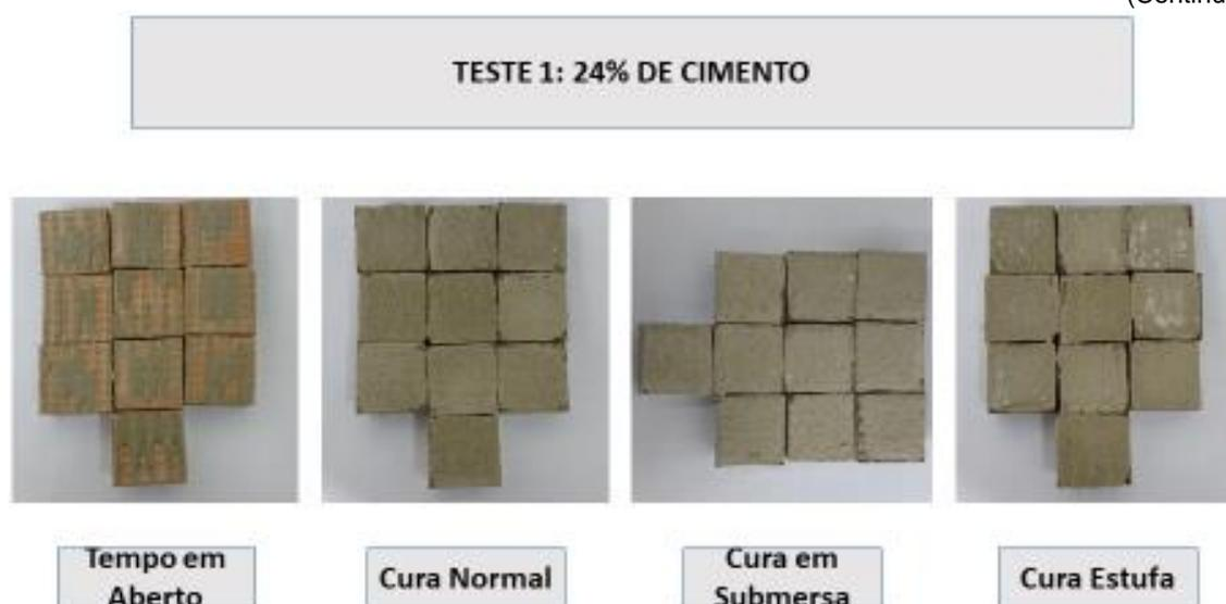
Figura 23 – Apresentação dos pontos de ruptura das amostras com 24% de cimento (Continuação)
