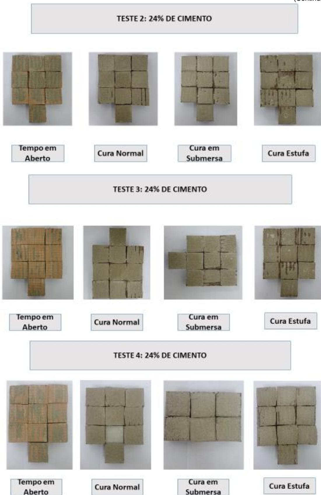
Figura 23 – Apresentação dos pontos de ruptura das amostras com 24% de cimento
