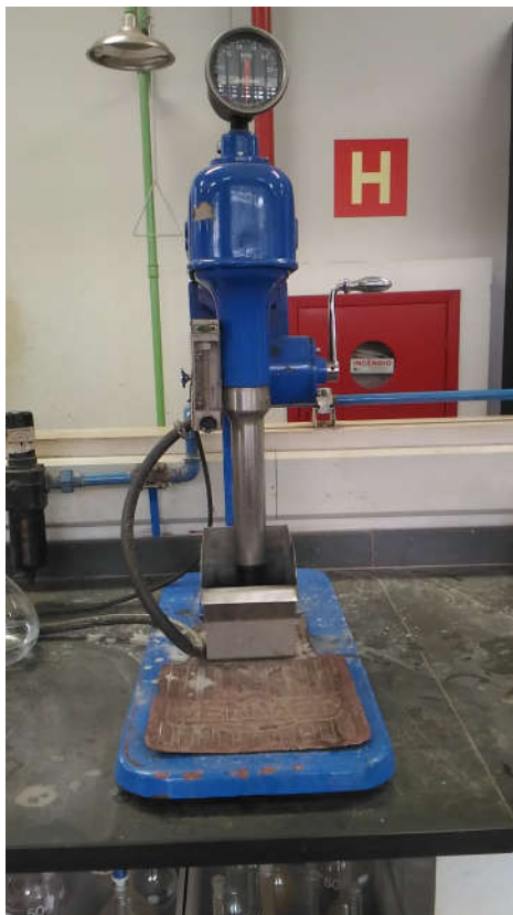
Figura 4-3. Célula de flotação em escala de bancada – LTM UFMG.
