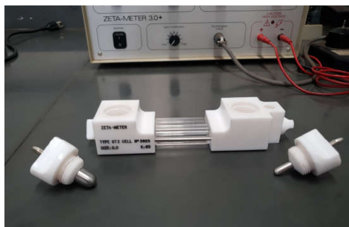
Figura 3-10. Célula utilizada para medição do potencial zeta.
