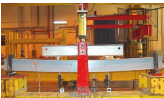
Figura 7-70: Perfil estrutural real submetido ao teste de fluência à flexão de quatro pontos (Sá, 2007)
