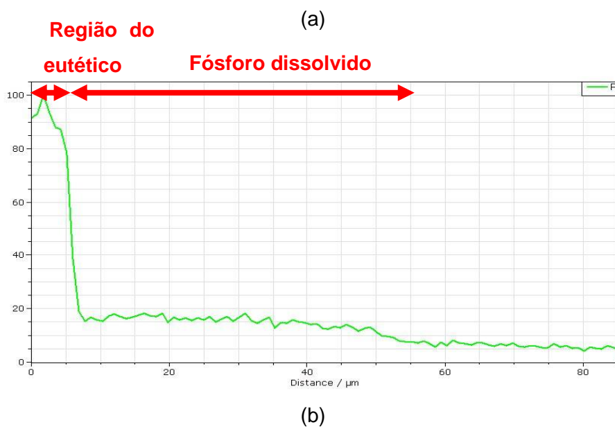
Figura 5-24: Fotos do corpo de prova do tipo charpy-impacto tratado a 1000°C, mergulhado no desoxidante com adição de 3% de SiO 2 , por um tempo de 1 hora: (a) secção transversal e polida do corpo de prova, (b) perfil de fósforo durante análise em line-scan.
