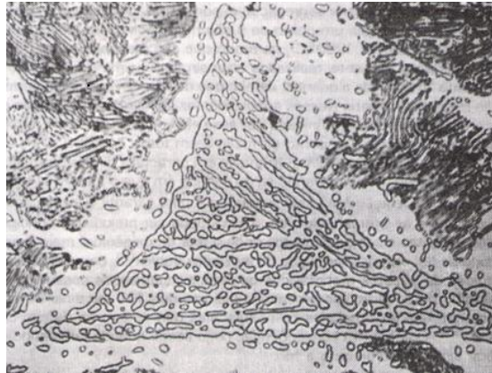
Figura 3-7– Aspecto micrográfico de aço meio doce moldado com alto teor de fósforo notado pela presença de um eutético fosforoso, existente quando o teor de fósforo se situa em torno de 0,4%. Ataque de Nital com aumento original de 700 vezes (6).
