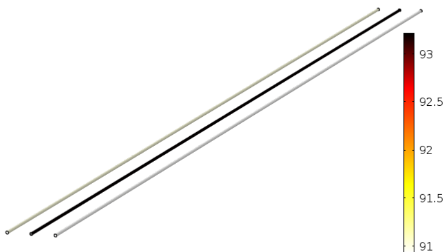
Figura 5.14 - Distribuição da temperatura (°C) dos condutores ao longo do sistema subterrâneo sobre o efeito da blindagem da chapa plana infinita.
