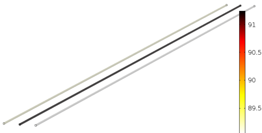
Figura 5.15 - Distribuição da temperatura (°C) dos condutores ao longo do sistema subterrâneo sobre o efeito da blindagem da chapa em “H” infinita.
