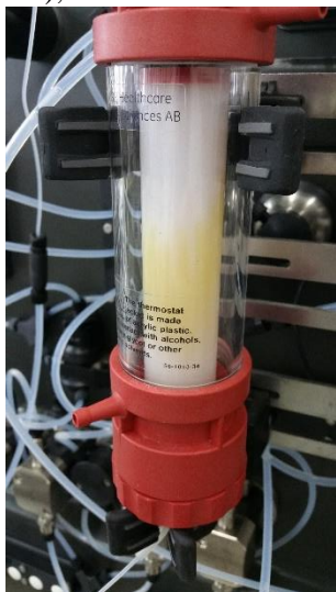
Figura 4.4 – Coluna XK 26/20 (GE Healthcare, Suécia) utilizada nas purificações das toxinas beta e épsilon de Clostridium perfringens .
