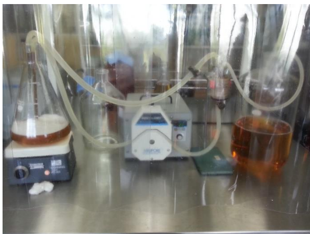
Figura 4.2 – Foto do sistema de ultrafiltração tangencial utilizado para a concentração e diafiltração dos sobrenadantes de cultivo bacteriano. Laboratório de Produção de Materiais de Referência do LANAGRO-MG.
