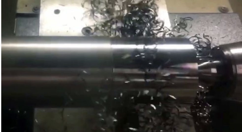
Figura 3-20 - Cavaco no formato de fita durante a usinagem. Fonte: Dados da pesquisa.
