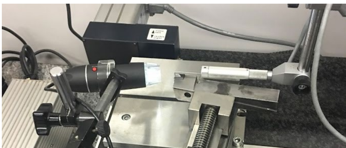
Figura 2-12 - Apalpador TKU instalado no perfilômetro Hommel Etamic T8000, coletando o perfil do desgaste de flanco de um inserto modificado.
