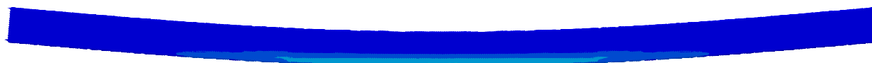
Figura 5-16-Dano à tração no concreto no vão central do modelo VP 250x150x6,4 no Ponto II para viga mista com protensão e consideração de 500 dias de fluência.
